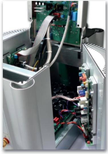
Zwei Leistungsverstärker befinden sich links und rechts auf eigenen Kühlkörpern aus massivem Aluminium, die aufgrund ihrer hohen Masse anfallende Verlustwärme optimal verteilen und mühelos abführen.
